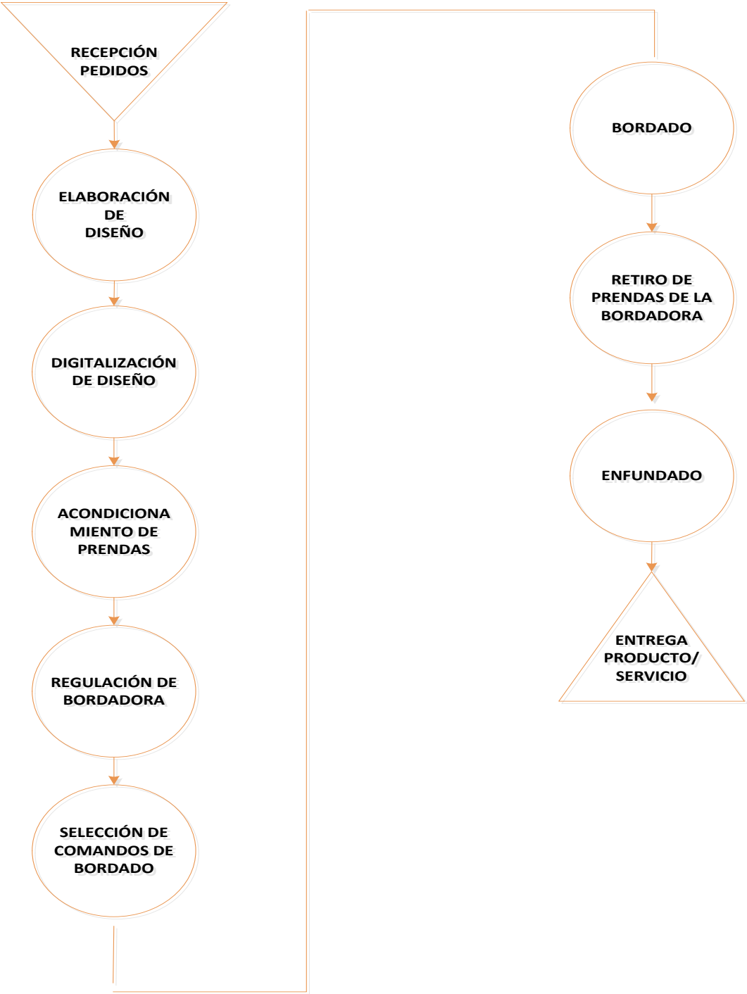
Gráfico N° 27.-Flujograma del proceso de bordado computarizado
